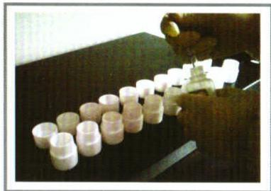
2.加入适量消解用酸，所用酸须经过提纯或者选用MOS级以上高纯酸，密闭，准备放入溶样罐外罐内；
