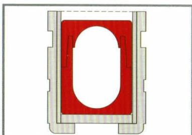
6.把密闭的聚四氟乙烯内胆置于罐体内，检查是否安放正确，此时，内胆顶面距离罐体上边缘高度约为3mm左右；
