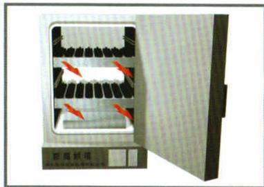
14. 防腐烘箱内温度降至室温后，取出罐体架，再依次取出防腐高效溶样罐；
