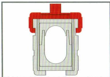
8.调整压力螺栓与盖体部分，使得压力螺栓下底面与盖体内表面平齐；
