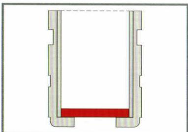
5.取出一个防腐垫片，置于安装有衬套的罐体中，检查垫片是否平整；
