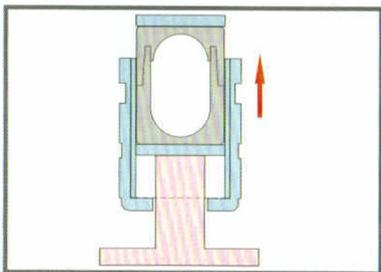
17. 取罐器通过罐体圆孔，把聚四氟乙烯内胆顶出罐体，取下内胆，并进行下一步工作；
