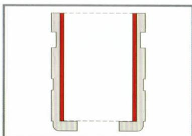
4.放入防腐衬套，检查衬套上边缘与罐体上边缘平齐；
