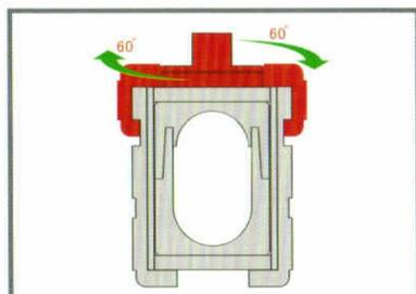
9.盖体三卡口准确对准下罐体三凹槽，轻轻推下，盖体三卡口上面低于罐体三卡口面，左旋60°左右，旋不动为止，有其他异常，请重新检查；
