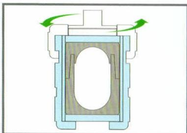
15. 拧力工具右旋180°，盖体右旋60°左右，取下盖体部分；
