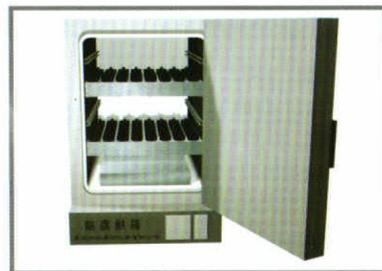
12.打开防腐烘箱门，把罐体架放入防腐烘箱搁架上，关闭烘箱门；
