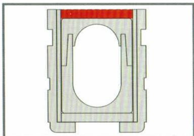
7.取一个防腐垫片，置于聚四氟乙烯内胆顶部，检查垫片是否安装正确，此时垫片高出罐体边缘1mm左右；
