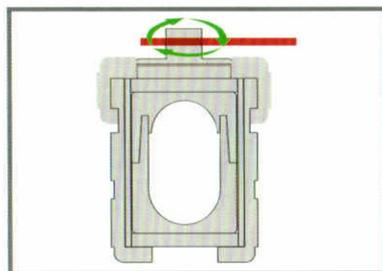
10.拧力工具调整压力螺栓，左旋大约旋转180°左右，操作完成，如出现无着力效果或者旋转角度交大，请重新检查，安装是否正确；
